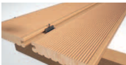
Der Terrassengleiter wird vormontiert, der vorhergehende Gleiter endgültig angezogen. Danach kann das nächste Brett angelegt werden
