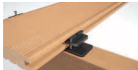
Liegt die Terrassendiele korrekt an wird der nächste Terrassengleiter aufgesetzt und in die Nut (mind. Breite 5 mm und 10 mm mind. Tiefe) des Belagbretts gesteckt
