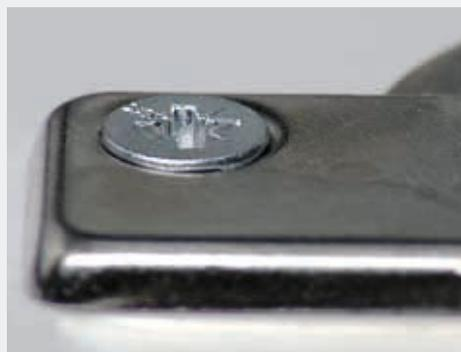
**Der Kombikopf passt genau in eine 90°-Senkung. Dank der hinterschnittenen Frästaschen reibt die Fräskante nicht an der Beschlagoberfläche, die Schraube liegt flächig im Beschlag an. Dadurch wird die Beschlagoberfläche beim Einschrauben nicht beschädigt.**
