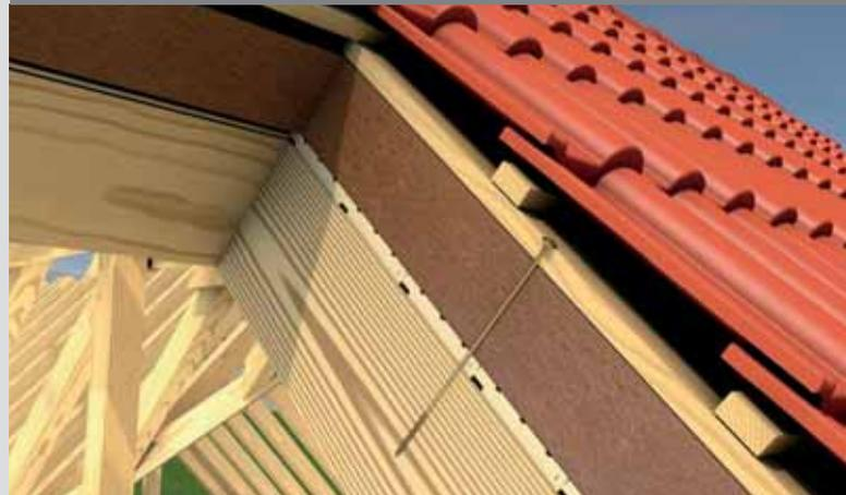
Standardlösung zur Befestigung der Sparren in Schwellen und Pfetten. Die Schraube kann ebenfalls als Sogschraube für die Befestigung der Konterlatten eingesetzt werden. Der Tellerkopf ermöglicht deutlich höhere Ausziehungswiderstände im Vergleich zum Senkkopf.
