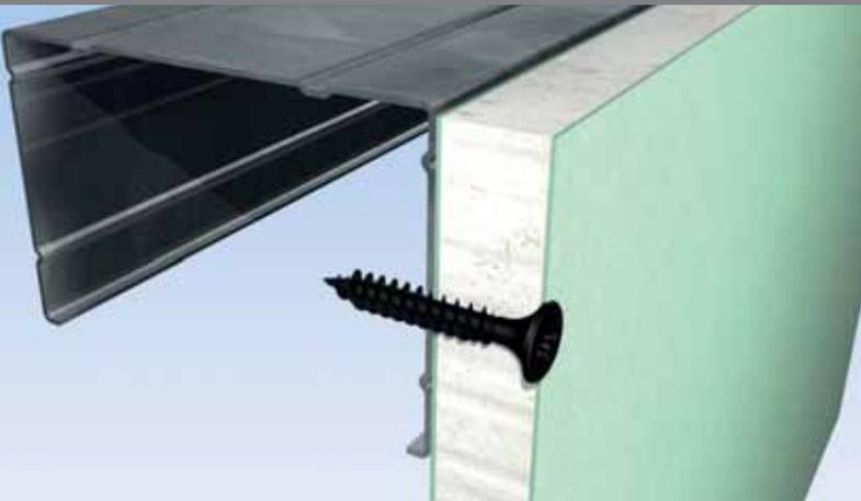
Mit Feingewinde zur Befestigung von Gipskartonplatten auf bis zu 0,7 mm starken Metallprofilen, ohne Vorbohren. Auch als gegurtete Variante für die serielle Verarbeitung im Langbandsystem für Streifenschrauber.
