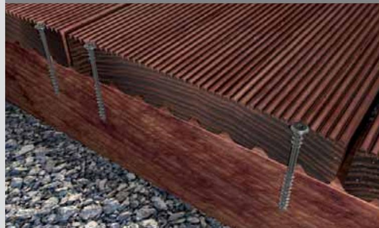
Der dickere Schraubendurchmesser sowie das Power-Fast Gewinde ermöglichen ein sicheres und spaltfreies Befestigen, auch von Harthölzern. Zudem werden Knarz-Geräusche durch das Unterkopfgewinde wirkungsvoll und dauerhaft vermieden (Vorbohren empfohlen).
