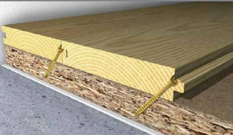
Der kleine 60° Senkkopf wurde speziell für die nicht sichtbare Verschraubung, in der Feder von Massivholzböden konzipiert. In Verbindung mit der Power-Fast Gewindegeometrie, lässt sich die Schraube ohne Vorbohren des Holzes schnell und einfach montieren.
