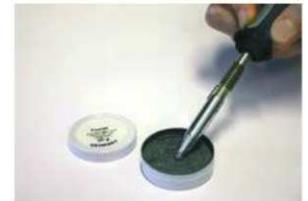
**Anwendung:** Die aufgeheizte Lötspitze wird auf der Oberfläche der Regenerationsmasse abgestreift.
