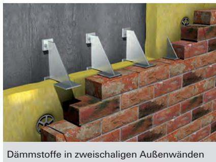
Dämmstoffe in zweischaligen Außenwänden
