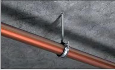
Zum größten Teil werden Rohre und Versorgungsleitungen in trockenen Innenräumen verbaut. Von daher werden neben korrosionsbeständigen Materialien wie Kunststoffen oder Edelstahl und Kupfer die für Installationssysteme verwendeten Stahlprodukte galvanisch verzinkt. Standard ist eine Zinkschichtdicke von 5-8  $\mu\text{m}$  die mittels elektrolytischem Verfahren (galvanisches Verzinken) hergestellt wurde.
