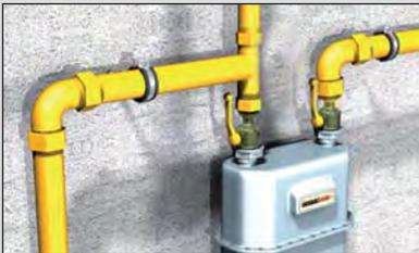
Auf Basis der DVGW-TRGI Neufassung im Jahr 2008 hat sich für die Befestigung von Rohrleitungen eine Konkretisierung für die einsetzbaren Dübel ergeben. Geregelt wird dies in der TRGI 2008 im Kapitel II unter Punkt 5.3 "Erstellung von Leitungsanlagen". In der TRGI aus dem Jahr 2008 sind nun unter bestimmten Bedingungen Kunststoffdübel ausdrücklich erlaubt.
