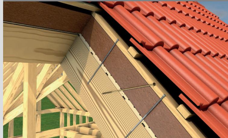
Haben Dämmstoffe eine Druckspannung bei 10 % Stauchung  $< 0,05 \text{ N/mm}^2$ , spricht man von einem weichen Dämmstoff. Für die Ableitung der Dachlasten wird in diesem Fall zwingend eine sogenannte Doppelgewindeschraube vorgeschrieben.
