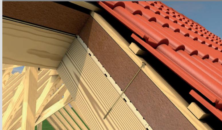
Standardlösung zur Befestigung der Sparren in Schwellen und Pfetten. Die Schraube kann ebenfalls als Sogschraube für die Befestigung der Konterlatten eingesetzt werden. Der Tellerkopf ermöglicht deutlich höhere Kopfdurchziehkräfte im Vergleich zum Senkkopf.
