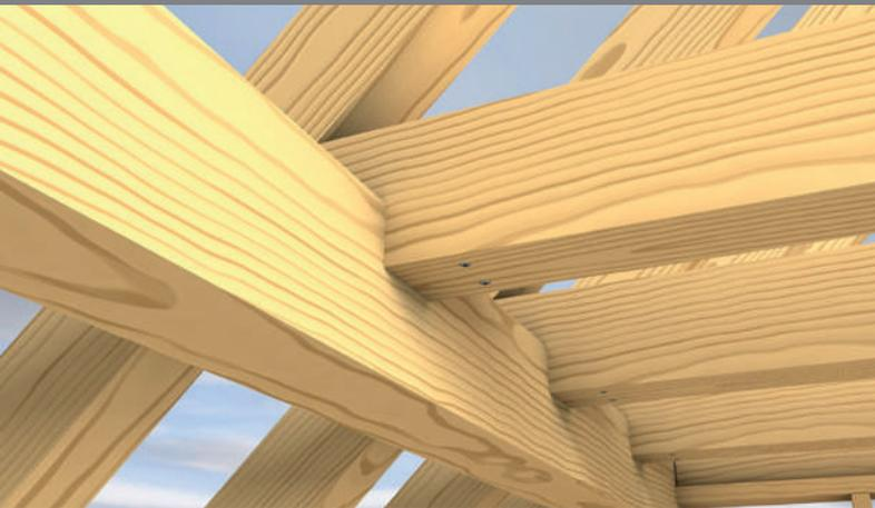
Trägerausklinkung am Auflagerbereich zur Verringerung der Bauteilhöhe (z.B. bei der Altbausanierung). Mittels Vollgewindeschrauben kann die Querkzugfestigkeit erhöht werden.
