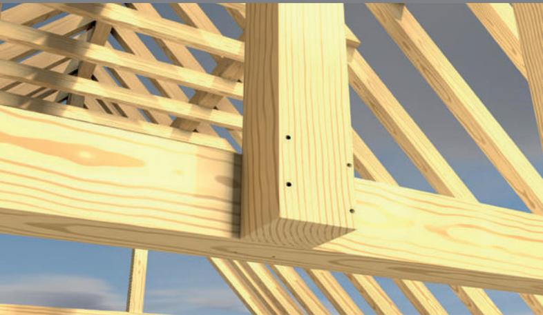
Rechtwinklig zur Holzfaser belastete Holzbauteile weisen eine erhöhte Querzugbeanspruchung auf. Durch den Einsatz von Vollgewindeschrauben kann eine Reduzierung der Tragfähigkeit vermieden werden.
