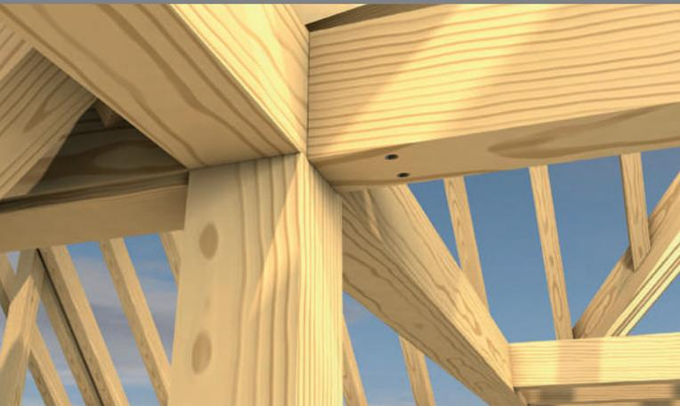
Haupt-Nebenträgeranschlüsse können im Vergleich zu alternativen Blechverbinderlösungen ebenfalls mittels Vollgewindeschrauben, welche unter einem Einschraubwinkel von 45° eingedreht werden, ausgeführt werden.
