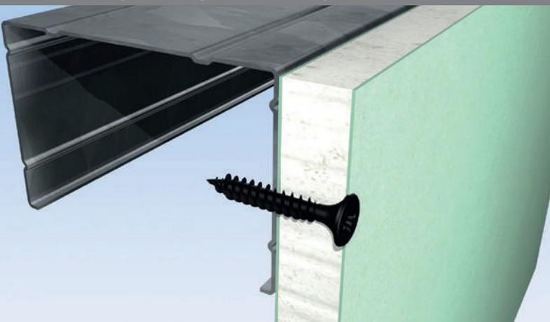
Mit Feingewinde zur Befestigung von Gipskartonplatten auf bis zu 0,7 mm starken Metallprofilen, ohne Vorbohren.
