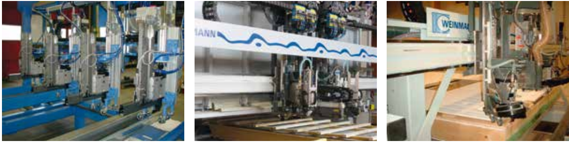
Heftstation, Integration in eine Fertigungsstrasse
