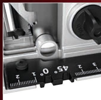
Schnittanzeiger 0° bis 45° für den Freihand Einsatz nach Anriss
