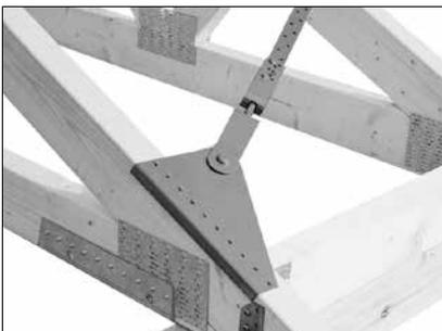
Detail am Traufpunkt: Bandanschluss BNF25 mit Spanngerät BNSP25 auf der Oberseite des Sparrens befestigt.
