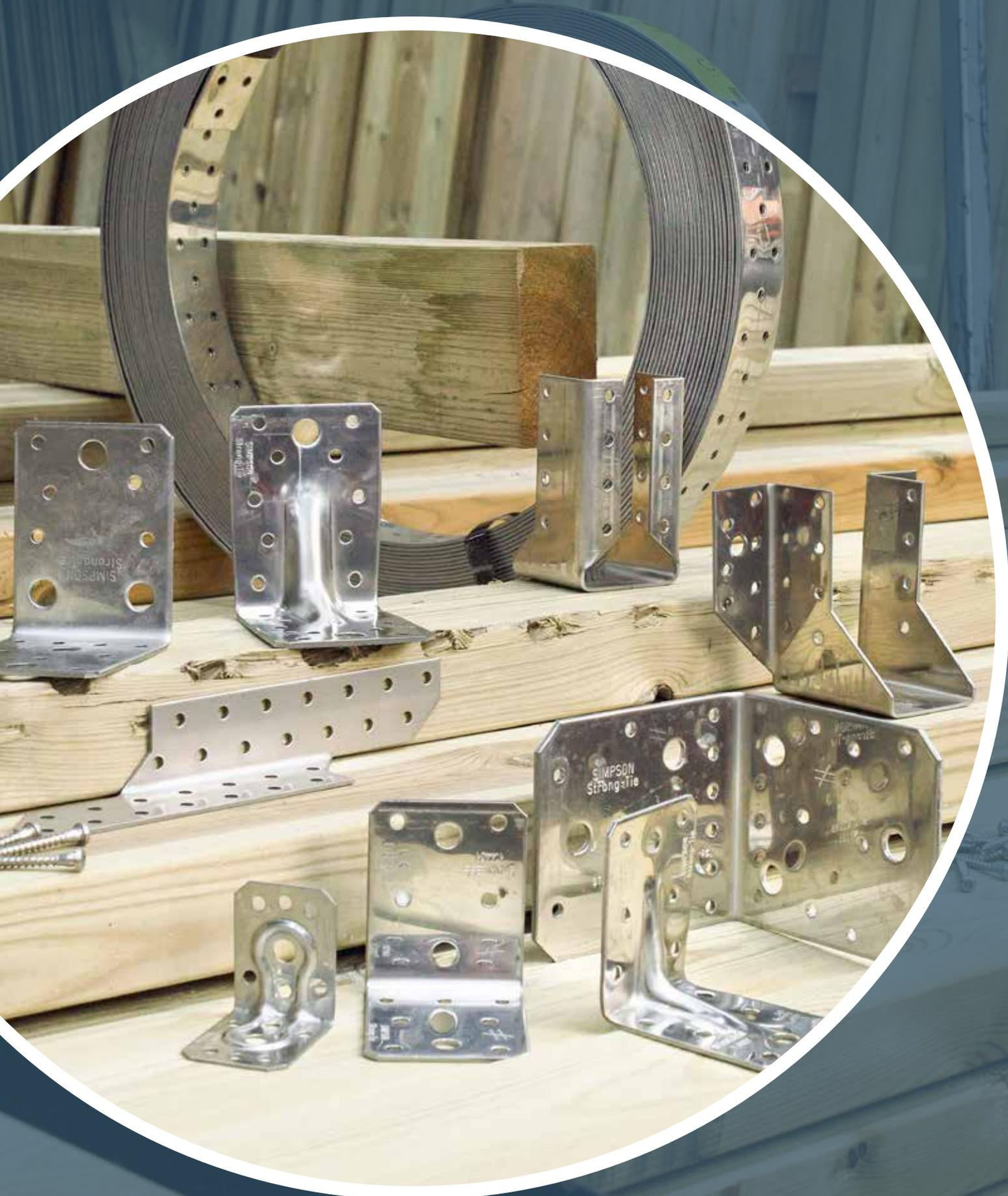
Die nachfolgend aufgeführten Holzverbinder sind Standardartikel in rostfreier Ausführung. Unsere Holzverbinder werden aus den Werkstoffen 1.4401 (AISI316) oder 1.4404 (AISI316L) hergestellt. Die rostfreien Standardholzverbinder können in Konstruktionen mit besonderen Anforderungen an die Korrosionsbeständigkeit eingesetzt werden. Die von uns am meisten verwendeten Edelstahlorten sind der Korrosionswiderstandsklasse III gemäß EN 1993-1-4(A1) zugeordnet.
