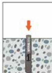
3. VAC Mörtelpatrone in das Bohrloch setzen
