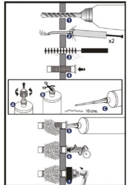
EINBAU MIT KUNSTSTOFF-ANKERHÜLSE
