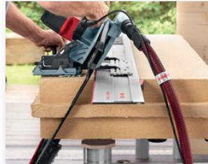
Für exakte Neigungsschnitte kann die DSS 300 cc per Skala stufenlos bis 60° eingestellt werden. Der Schnitt kann anschließend mit Zusatzauflage auf oder neben der Führungsschiene durchgeführt werden.
