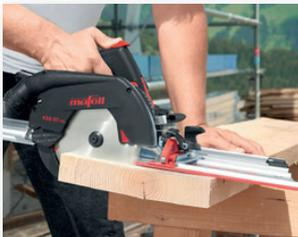
Alles aus einer Hand: Bei der Kappschiene-Säge sind Maschine und Führungsschiene fest miteinander verbunden.
