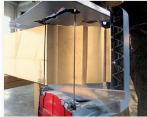
Dank hohem Drehmoment sind für die Z 5 Ec Einsätze in Massivholz mit Schnitttiefen von 305 mm kein Problem.
