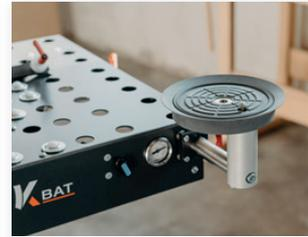
Zur sicheren Nachbearbeitung der Kante kann das Werkstück mit der Vakuumplatte fixiert werden. Ein Tastventil schaltet diese bei Nichtgebrauch ab.
