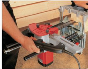
Fräseinrichtung mit dem SG 230 – vertikal und horizontal.
