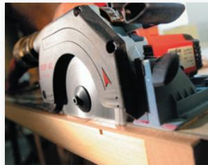
Optimale Handlichkeit und Schienenführung. Zwei Garanten für hohe Präzision, wie hier beim Ablängen von Zimmertüren.
