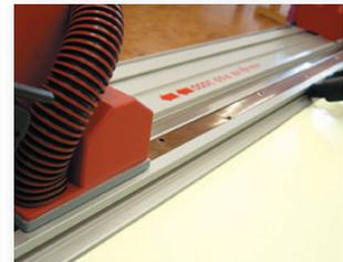
Über den MAFELL-Sauger S 50 M und den integrierten Absaugkanal werden Staubpartikel fast vollständig abgesaugt.
