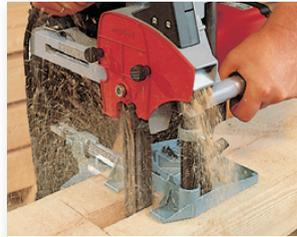
Der LS 103 Ec mit dem Führungsgestell FG 150 für Stemmtiefen bis 140 mm.
