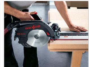
Die KSS 80 Ec/370 kann einfach und schnell von der Systemschiene getrennt und auf eine bestehende Führungsschiene aufgesetzt werden.
