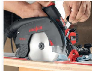
Der FLIPPEL ermöglicht – auch ohne Abschrauben des Spaltkeils – einen sicheren, bequemen und einfachen Tauchschnitt.
