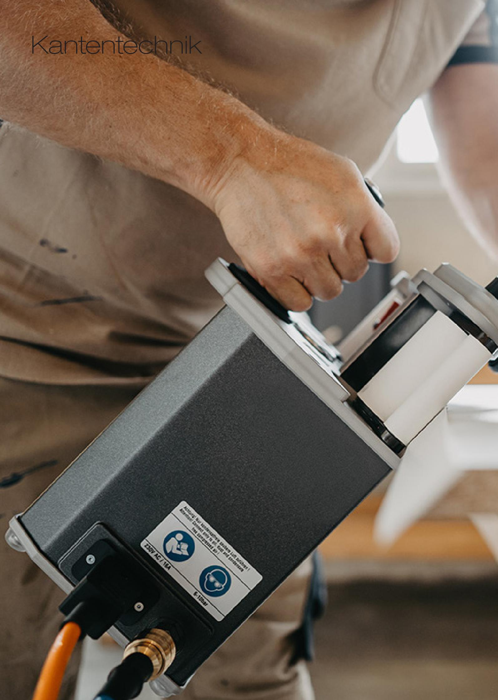
**Der HIT-M ist das erste und einzige mobile Gerät zur Erstellung einer optischen Nullfuge. Mit der Heißluft-Injektions-Technik lassen sich alle handelsüblichen Nullfugen-Kanten mit aufgetragener Funktionsschicht bearbeiten - ohne den Einsatz von zusätzlichem Kleber.**
