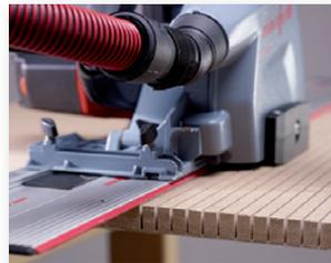
3 Schlitz pro Arbeitsgang mit dem MF-SE 3. Mit dieser Biegetechnik lassen sich schnell und einfach gebogene Werkstücke herstellen.
