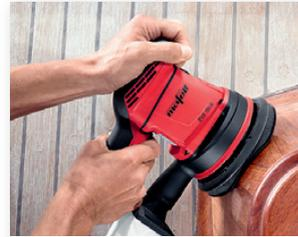
Mit der niveauequalisierenden Softauflage lassen sich beste Arbeitsergebnisse an konkaven und konvexen Flächen erzielen. Der Schaumstoffpad gleicht Unebenheiten aus und sorgt für gleichmäßige Schleifergebnisse.
