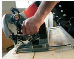
Der Parallelenschlag und die satten Leistungsreserven des Hochleistungsmotors CUprex sorgen für eine präzise Führung und einen sicheren Schnitt.
