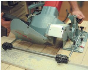
Die ZK 115 Ec mit der Führungsschiene.
