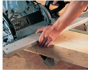
Idealer Einsatzbereich z. B. für Schifterschnitte. Die Universalführung im Sonderzubehör.
