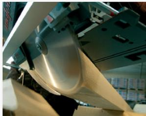
Ideal für Schifterschnitte: die MKS 130 Ec kann bis 60° geneigt werden. Die maximale Schnitttiefe beträgt dann immer noch enorme 65 mm.
