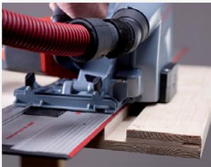
Mit dem Verstellnuten MF-VN 25 können Nuten für Stellbretter oder Versorgungsleitungen effektiv und schnell eingefräst werden.
