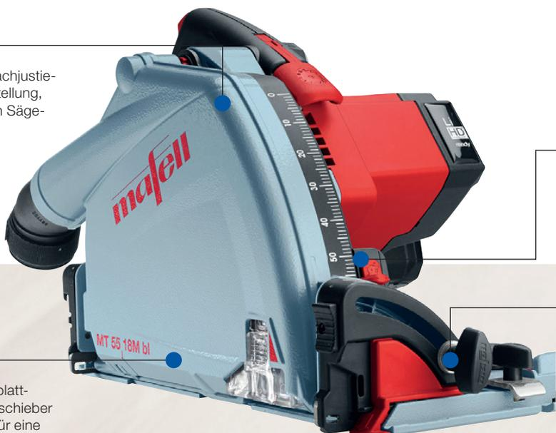
Die Schnitttiefe kann millimetergenau justiert werden. Mit oder ohne Schiene – durch einfaches Drehen des Schnitttiefezeigers wird immer die exakte Schnitttiefe angezeigt.
