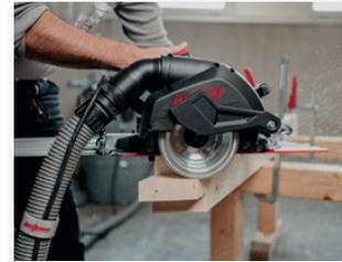
Einzelne Zapfen lassen sich mühelos mit der NFU 50 und der Führungseinrichtung L durchführen.
