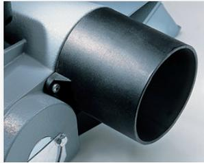
Das immense Spänevolumen wird mit Hilfe eines verstärkten Luftstromes mit neuartiger rotierender Luftführung ausgeblasen.
