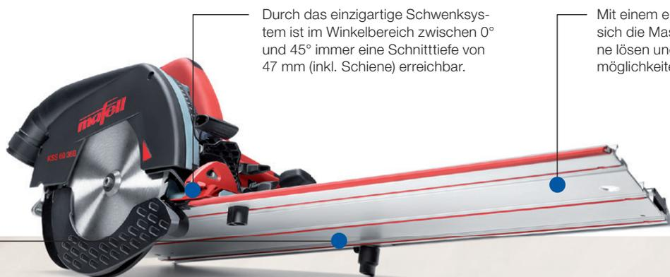
Durch das einzigartige Schwenksystem ist im Winkelbereich zwischen 0° und 45° immer eine Schnitttiefe von 47 mm (inkl. Schiene) erreichbar.
