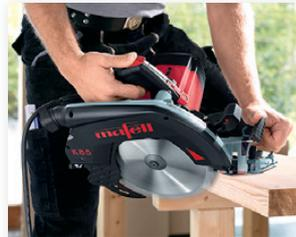
Durch den Pendelhaubenvoreinzug am zweiten Handgriff, ist speziell bei Schrägschnitten, das Ansetzen der Maschine komfortabel und sicher.
