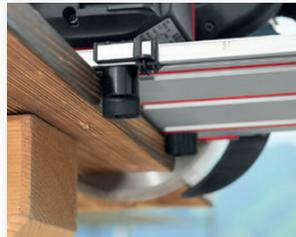
Der fixe und der einstellbare Anschlag an der Unterseite der Schiene sorgen dafür, dass das System für Winkelschnitte von +60° bis -60° eingesetzt werden kann.
