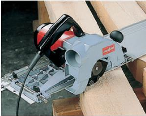
Führungseinrichtung mit Winkelanschlag und Adapter als Sonderzubehör.
