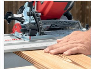
Dank großdimensionierter Winkelskala lassen sich Gehungsschnitte passgenau umsetzen. Wie hier am Beispiel einer Fassadenschalung.
