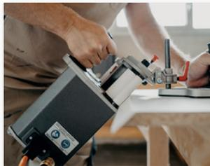
Für schräge Plattenkanten kann die Auflageplatte bis 50° geschwenkt werden.
