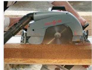
In Kombination mit dem Absauggerät S 50 M und der Führungsschiene sorgt die MKS 130 Ec überall für einen sauberen und genauen Schnitt, auch in problematischen Dämmmaterialien.
