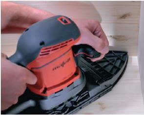
Egal ob an Ecken, Kanten oder anderen schwer zugänglichen Stellen – wenn Detailgenauigkeit gefordert ist, sorgt die Delta-Schleifplatte mit Leichtigkeit für perfekten Schliff.
