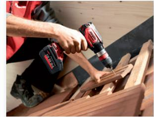
Der ASB 18 M bl vereint drei Akku-Geräte in einem: einen Schrauber, einen Bohrer und eine Schlagbohrmaschine.
