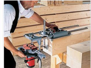
Hochpräzise Fräsungen für hochwertige Knotenblechverbindungen im Ingenieurholzbau.
