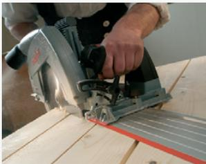
Für präzise Schnitte kann die MKS 130 Ec auf den Führungsschienen-System F eingesetzt werden.
