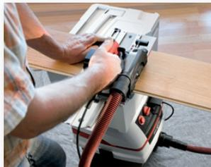
Der auf dem Absauggerät befestigte T-MAX kann als Auflage für kleinere Werkstücke eingesetzt werden.
