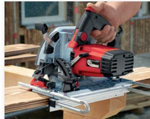
Mit den MAFELL Führungsschienen oder dem optional erhältlichen Untergreifanschlag mit Millimeter-Skala können beispielsweise Terrassendielen exakt eingepasst werden.
