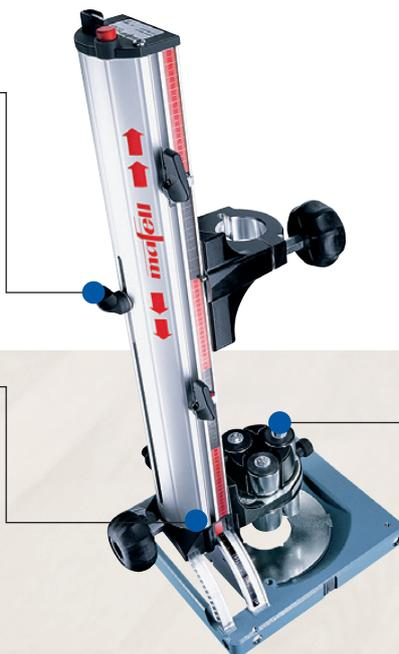
80 mm hohe Bohrerführung mit sechs vertikal gelagerten Rollen, die durch eine irisartige Einstellmechanik den Bohrer perfekt führen – damit wird das Verlaufen des Bohrers verhindert.
