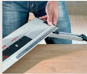
Die Einheit mit Winkelanschlag und Führungsschiene wird am Werkstück angelegt.
