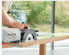
In Kombination mit der rollbaren Flexi-Schiene FX 140 sind präzise geführte Schnitte bis 1,4 m kein Problem.
