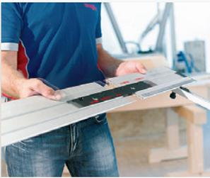
Der Winkelanschlag kann mittels dem Adapter mit allen F-Führungsschienen verbunden werden. Einfach den Adapter einsetzen, zusammenschieben und arretieren, fertig.
