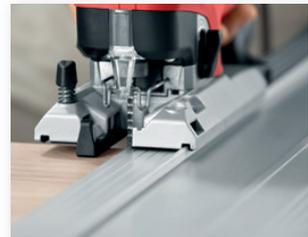
Für exakt gerade Schnitte lässt sich die P1 cc mit der MAFELL Führungsschiene F kombinieren.
