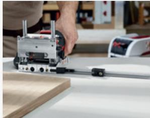
Das patentierte Anschlagssystem mit gefederten Anschlagstiften in der Grundplatte wurde einfach für den neuen Seitenanschlag SA 320 adaptiert.
