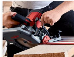
Dank großdimensionierter Winkelskala und präziser Doppelklemmung lassen sich Gehrungsschnitte passgenau umsetzen.
