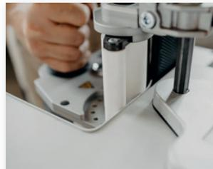
Speziell durch die ange- triebene Andruckrolle der SA-Variante sind extreme In- nenradien ab 10 mm mühelos umsetzbar.
