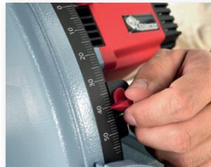
Mit oder ohne Schiene – durch einfaches Drehen des Schnitttiefezeigers wird immer die exakte Schnitttiefe angezeigt.
