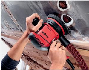
Für einen Grobschliff ist der EVA 150 E/5 die richtige Wahl. Hier sind die Voraussetzungen dank einem Schwinghub von 5 mm und 12.000 U/min optimal.
