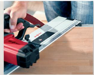
Das Werkstück kann jetzt im exakt eingestellten Winkel zugeschnitten werden.
