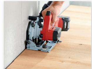
Perfekter Abschluss: Die Abstandhalter der Handkreissäge sorgen dafür, dass exakte Dehnfugen-Schnitte ab 13 mm Breite leicht von der Hand gehen.
