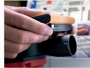
Die mechanische Klemmung für Rollenpapier spannt das Schleifpapier exakt und lässt das Papier nicht durchhängen.
