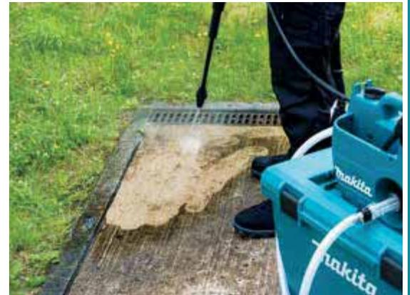
Wasserzufuhr aus der Transportbox als Wasservorrat
