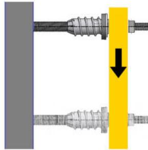
**Maximale Querlasten V <sup>1)</sup> bei max. 3 bzw. 5 mm Verschiebung bei verdrehbehinderter Lagerung des freien äußeren Endes des ResiTHERM® 16 bei 24°C/40°C <sup>2)</sup>**
