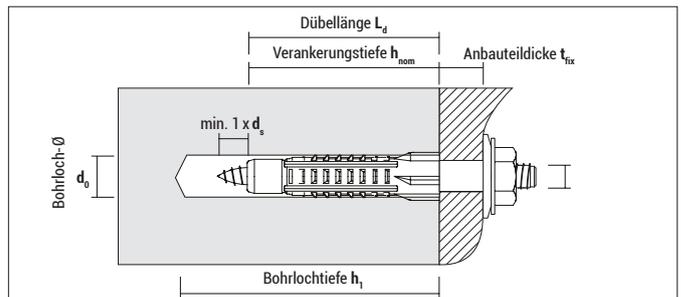
Mindestabstand zum Bauteilrand min. 1x Dübellänge
