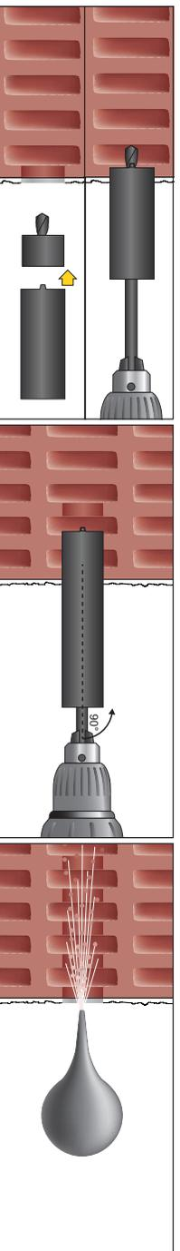
1. Anbohrhilfe auf Bohrkronen setzen und mittels Akkuschrauber (ohne Schlag) ca. 10 mm ins Mauerwerk bohren; danach Anbohrhilfe entfernen
