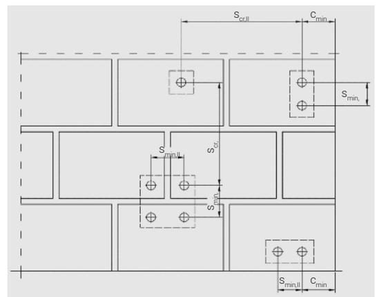
\* Werte gelten für Zuglastbeanspruchung; bei Querlast parallel zum freien Rand: 75 mm, bei Querlast senkrecht zum freien Rand:  $1,5 \times h_{ef}$
