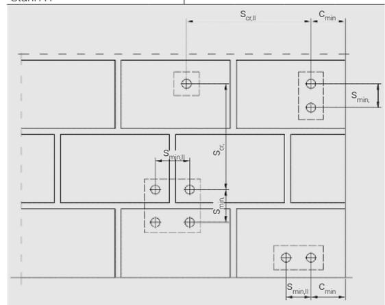
\* Werte gelten für  $S_{min,I}$ . Für  $S_{min,II}$  gilt 240 mm.
